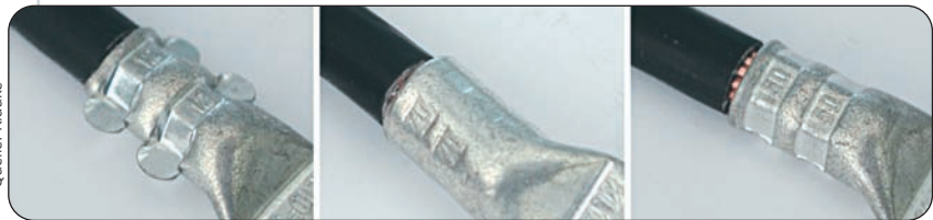
Bild 4: Falsche und korrekte Verpressung im Vergleich: eine nicht fachgerechte Verpressung (links Überpressung, Mitte Unterpressung) oder die Verwendung eines falschen Presswerkzeugs kann zu erhöhten Übergangswiderständen führen und die Sicherheit einer Anlage gefährden; rechts eine korrekte Pressung
