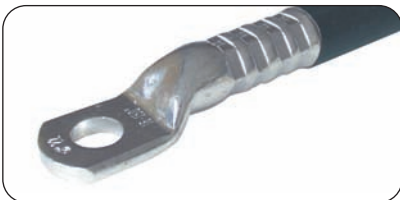
Bild 14: Werkzeugkennziffer auf dem Kabelschuh und eingeprägte Kennziffer weisen auf die korrekte Verpressung hin
