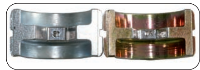
Bild 8: Presseinsatz links: für Aluminium, silberfarbig; Presseinsatz rechts: für Kupfer, gelb-gold eingefärbt
