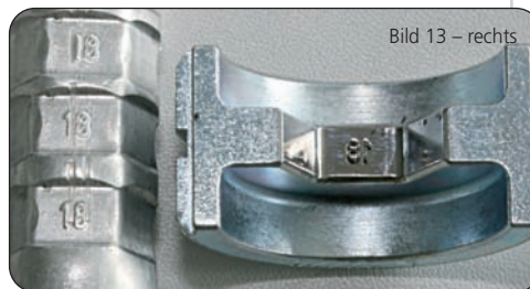
Bild 14: Werkzeugkennziffer auf dem Kabelschuh und eingeprägte Kennziffer weisen auf die korrekte Verpressung hin
