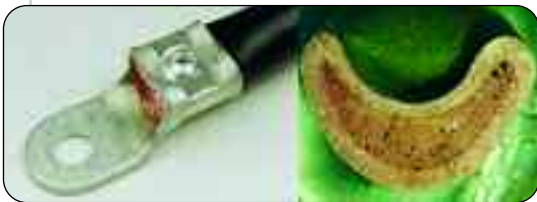
Bild 4: Die intensive Dornpressung stellt nur bei aufeinander abgestimmten Materialien sicher, dass trotz des großen Außendurchmessers eine dauerhaft sichere und »tief wirkende« Verbindung entsteht
