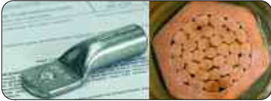
Bild 2: Bei der genormten Sechskant-Pressung können Kabelschuhe und Verbinder entsprechend der DIN 46235 mit geprüften Presseinsätzen nach DIN 48083 Teil 4 verwendet werden
