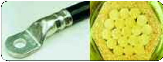
Bild 1: Die Sechskant-Pressung eignet sich sowohl für Kupfer- als auch für Aluminiumleiter. Ihr Vorteil liegt in der zentrischen Kräfteinwirkung, die damit auf eine große Kontaktfläche einwirkt
