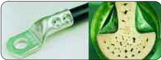
Bild 3: Bei Kerbungen handelt es sich immer um spezielle Verpressungen, die v. a. für fein- und feinstdrähtige Leiter erforderlich sind, um dauerhafte Verbindungen zu erzielen. Die zu verwendenden Pressprofile richten sich nach dem Querschnitt des verwendeten Kabels sowie der Kabelschuhe und Verbinder
