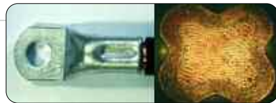
Bild 6: Die Form der Vierdorn-Pressung eignet sich für Rohrkabelschuhe und Verbinder mit Querschnitten von 10mm 2 bis 300mm 2 in Kombination mit Kabeltypen der VDE-0295-Klassen 2, 5 und 6
