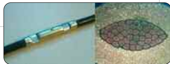
Bild 7: Die gasdichte Oval-Pressung stellt einen dauerhaft hohen Leitwert der Verbindungen sicher. Weder flüssige nach gasförmige Medien können unter normalen atmosphärischen Bedingungen eindringen. So wird eine Oxidation zwischen den verpressten Einzeldrähten verhindert und eine Erhöhung des Widerstands ist nahezu ausgeschlossen
