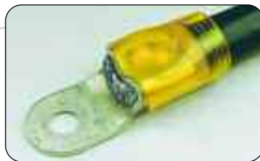
Bild 5: Kabelschuhe mit einer hochwertigen Isolation und speziell darauf angepasste Pressprofile stellen sicher, dass die Isolation durch den Pressvorgang nicht beschädigt wird
