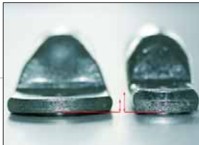
Bild 8: Der Anschraubflansch des SG-Kaabelschuhs (rechts) ist dicker, da bei der Herstellung durch ein spezielles Herstellungsverfahren die gleiche Menge an Kupfer wie beim Rohrkaabelschuh verwendet wird
