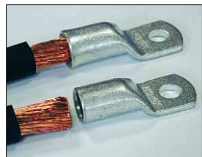
Bild 2: Rohrkabelschuhe Baureihe F (oben) für feindrätige Leiter ermöglichen das leichte Einführen des Leiters ohne das Aufspalten der Leiterdrähte
