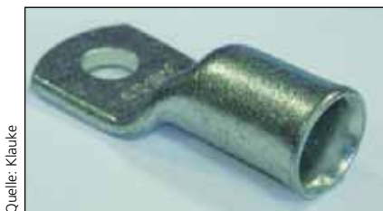
Bild 6: Wenn Kabel der Klassen 5 und 6 nicht in herkömmliche Kabelschuhe passen, kann man auf die aufgeweiteten F-Kabelschuhe ausweichen
