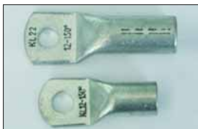
Bild 2: Nur der Presskabelschuh nach DIN 46235 (oben) weist die vom Hersteller vorgegebene Anzahl der Pressmarkierungen auf
