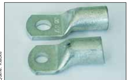
Bild 8: Hochwertige Rohr Kabelschuhe (oben) weisen eine saubere und senkrechte Endenbearbeitung auf
