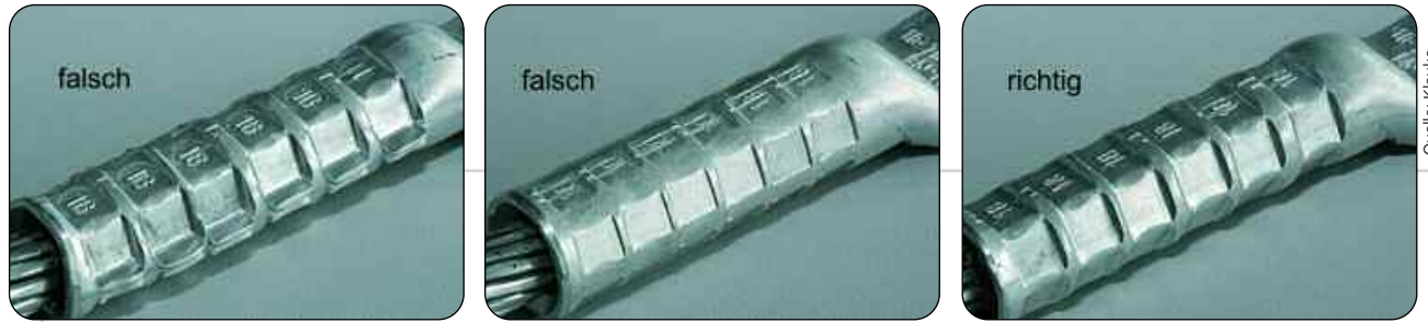
Bild 5: Die Überpressung (links) deutet auf einen zu kleinen, die Unterpressung (Mitte) deutet auf einen zu großen Presseinsatz hin. Bei einem korrekt verpressten Kabelschuh (rechts) wurde ein zum Kabelschuh passender Presseinsatz verwendet
