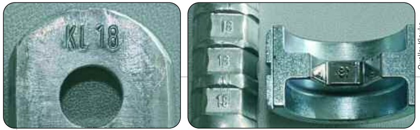
Bild 4: Der Aufdruck der Werkzeugkennziffer »18« auf dem Kabelschuh (links) gibt Auskunft über den zu verwendenden Presseinsatz. Die fertige Verpressung (rechts) mit der Prägung »18« auf dem Kabelschuh verweist auf den korrekt verwendeten Presseinsatz
