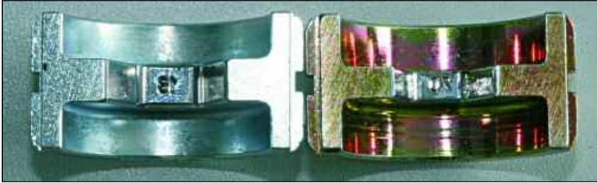
Bild 6: Die Kontaktfläche der Presseinsätze für Al-Kabelschuhe (links) sind um 2 mm breiter als die der Presseinsätzen für Cu-Kabelschuhe (rechts)
