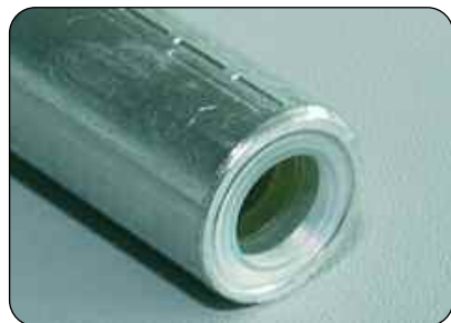
Bild 8: Kunststoff-Stopfen von qualitativ hochwertigen Kabelschuhen verhindern bei Lagerung das Austrocknen oder Auslaufen des Presszusatzes
