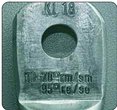
Bild 3: Markierungen auf den Kabelschuhen geben wichtige Hinweise zu Herstellerkennziffer, Anschlussbohrung, Querschnitt und Kabelzuordnung
